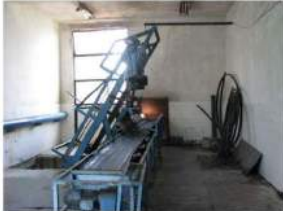
Slika br. 4.: Automatska ravna rešetka sa gumenim transporterom
